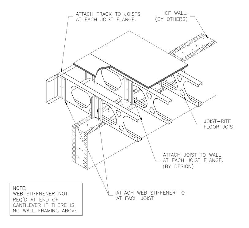
JOIST CANTILEVERED OVER ICF WALL
