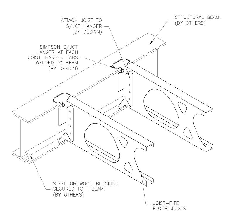
CONNECTION TO I-BEAM USING SIMPSON S/JCT HANGER
