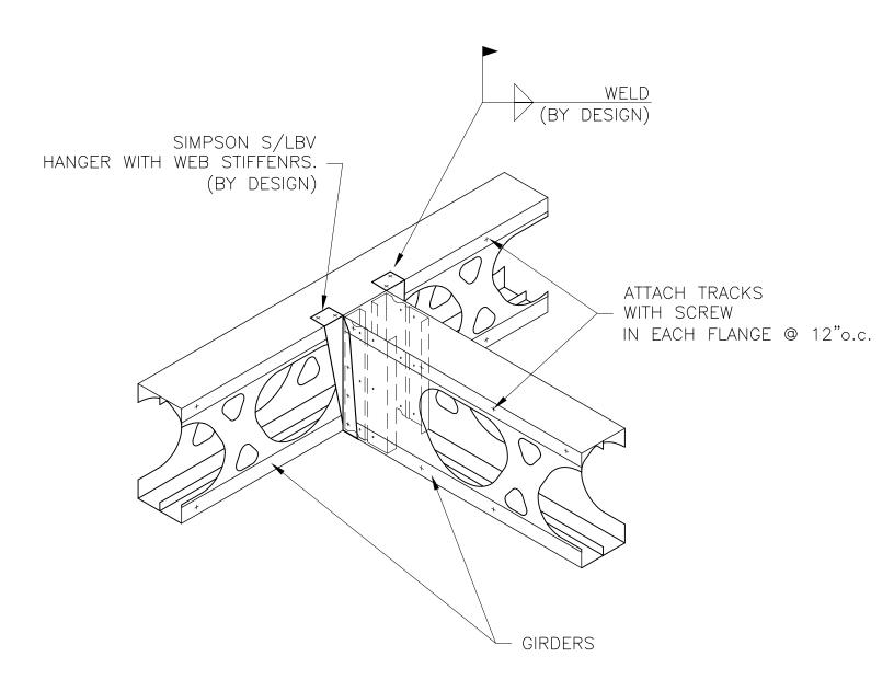
GIRDER TO GIRDER CONNECTION USING SIMPSON S/LBV HANGER
